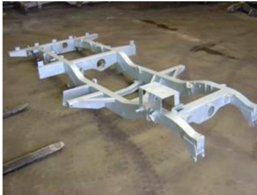
Fig.: Ladder Frame *Chassis*
